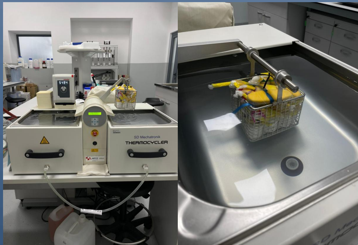
Slika 6. Uređaj za termocikliranje s uzorcima
