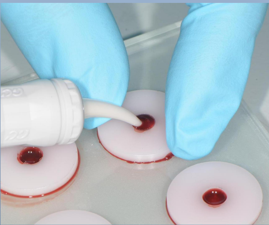
Slika 3. Istiskivanje zamiješanog materijala iz kapsule u teflonski kalup s humanom krvlju na staklenoj podlozi
