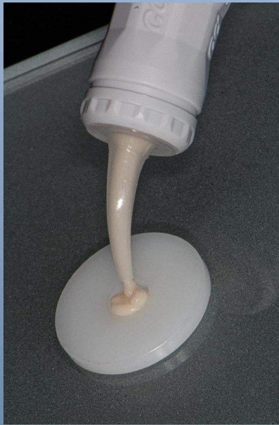
Slika 1. Istiskivanje zamiješanog materijala iz kapsule u teflonski kalup
